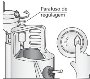
**Descarga total:** Regule o volume da descarga total deslizando o regulador azul para cima ou para baixo. Quando o regulador está alto, o volume de água descarregada é menor. Aperte o botão de descarga total (três gotas). Certifique-se que ocorreu a limpeza completa na bacia sanitária. Se não ocorrer, abaixe a regulagem da descarga total para o nível seguinte, aperte o botão novamente, repita este procedimento até funcionar corretamente a descarga.
