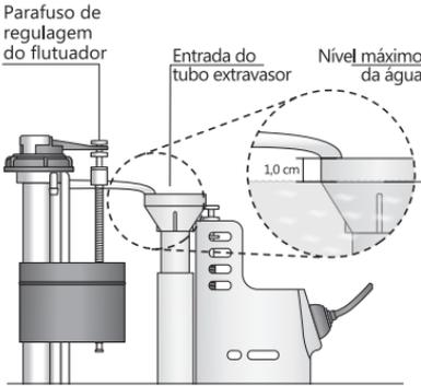
Para regular a altura da água dentro da caixa acoplada é necessário ajustar o parafuso de regulagem do flutuador. Gire o parafuso no sentido horário para subir e no sentido anti-horário para baixar o nível de água na caixa acoplada.
